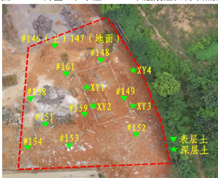
图 2.5-2 片区 2 表层、深层土壤检测布点图
