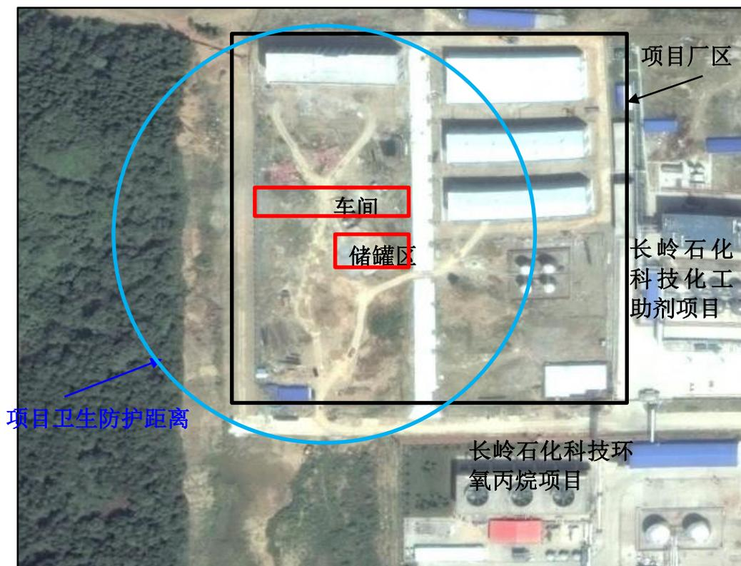
图 4.2-4 卫生防护距离包络线图
