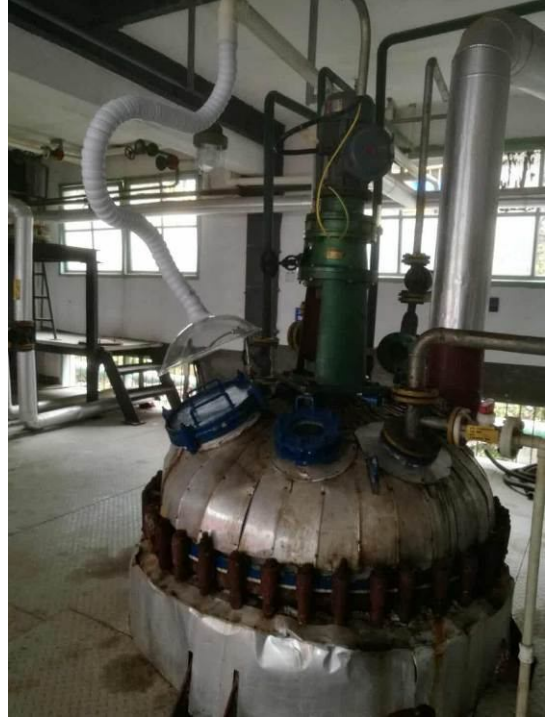
精细车间（精细加料口废气收集）
