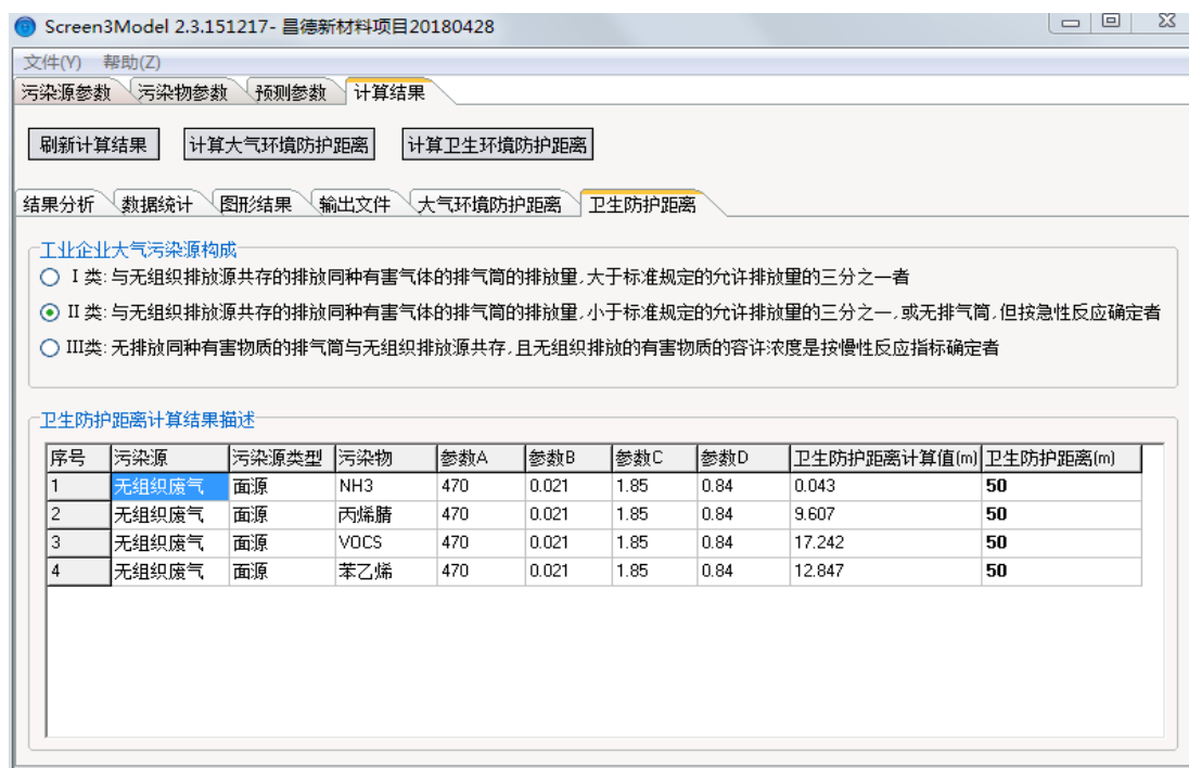
图 6.2-2 无组织排放-苯乙烯、丙烯腈、NH 3 、VOCs 卫生环境保护距离预测结果
