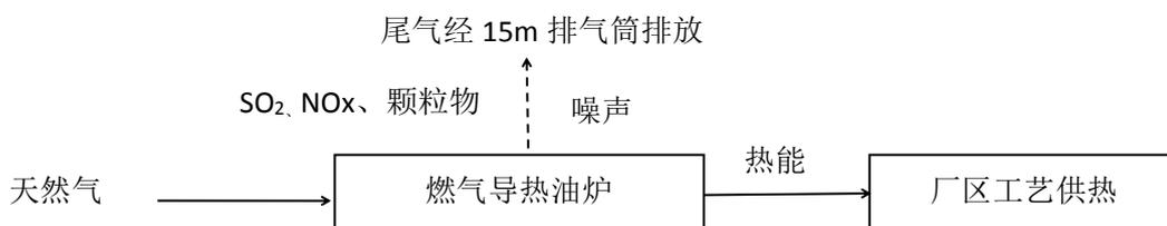
图 5-2 第二阶段燃气锅炉工艺流程及产污环节图
