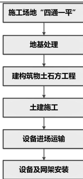
图 1 变电站工程施工工艺流程
