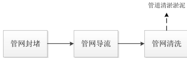
图 2.2-3 管网清淤施工流程及产污环节图
