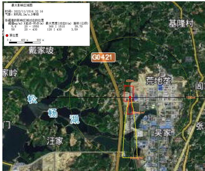
图7.4-2 氯预测浓度达到不同毒性终点浓度的最大影响范围示意（最不利气象条件）
