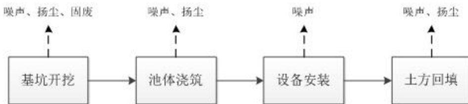
图 2-2 理工学院合流制溢流污水调蓄池工程施工工艺流程及产排污环节图
