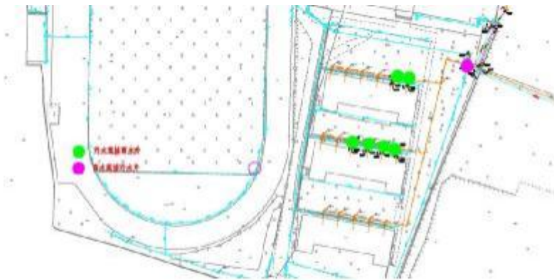
图 1-6 云梦中学现状排水管网图
