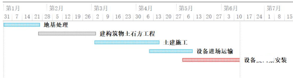
图 3 变电站改造工程施工时序图
