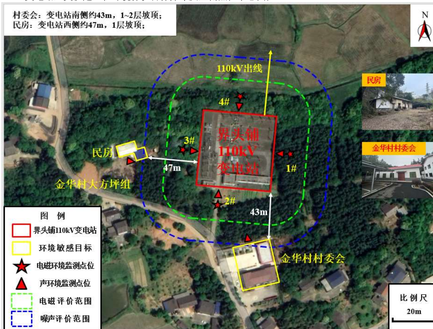
附图 7: 界头铺 110kV 变电站主变扩建工程环境保护目标分布及监测点位示意图;
