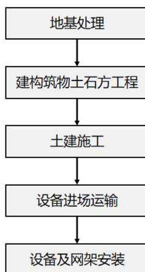
图 2 变电站间隔扩建工程施工工艺流程
