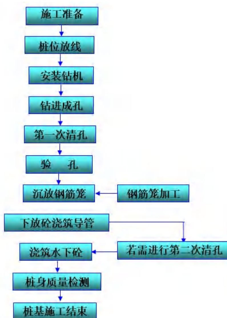
图 2-6 钻孔灌注桩施工工艺流程图
