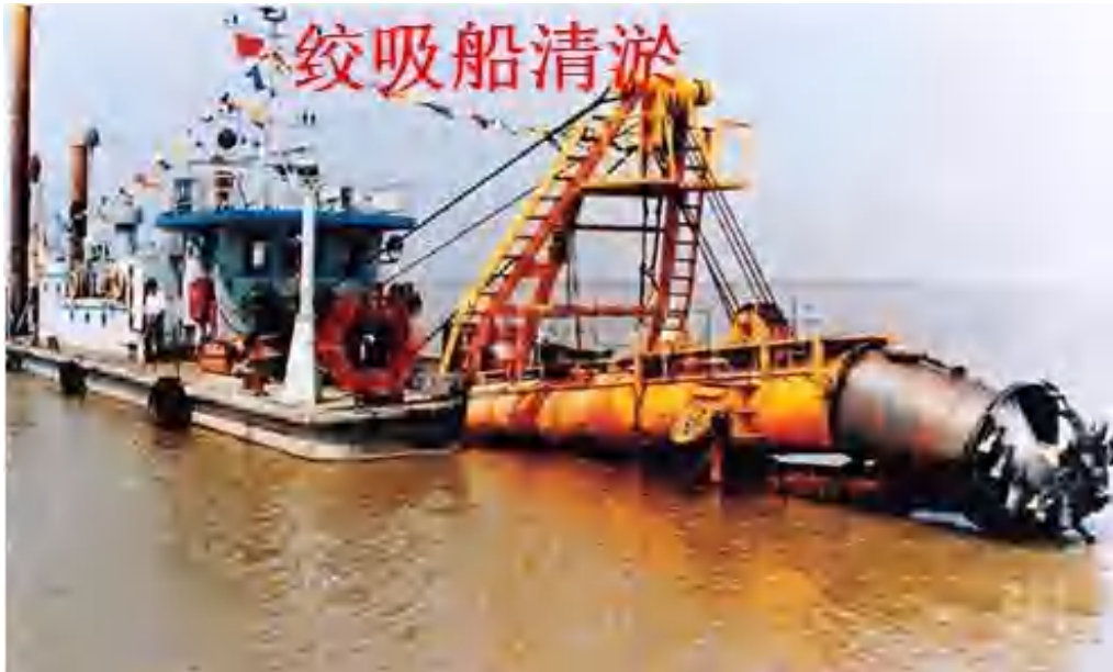
图 2-7 环保型绞吸船样图
